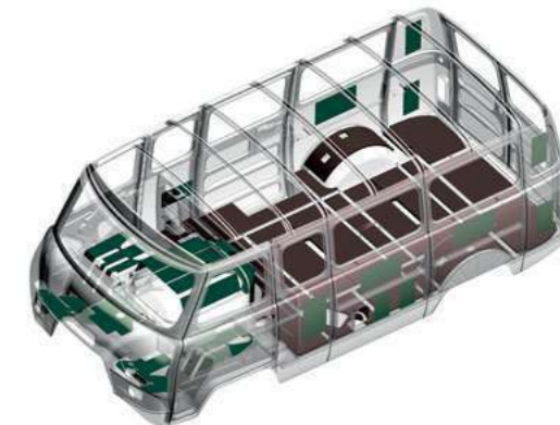
Пакет вибро- и шумоизоляции по всему кузову и специальные подушки крепления кузова
